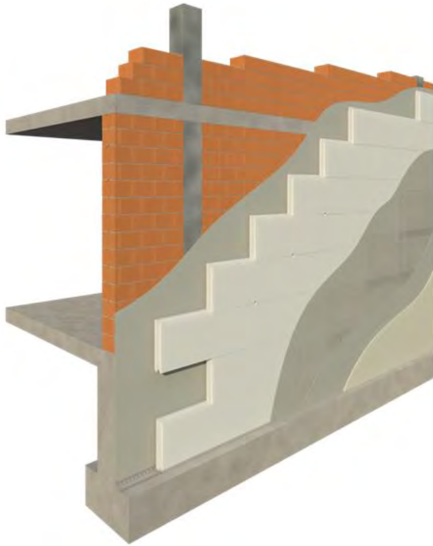
Fachada Termoarcilla con SATE
