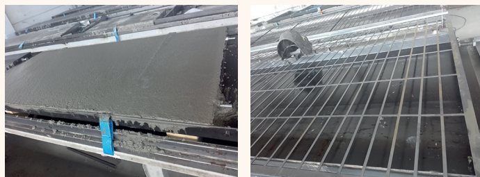
Figura 3. Llenado de moldes y comprobación de plantillas
