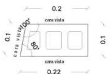
PIEZA 3.3 LADRILLO DE FACHADA ESQUINA ÁNGULOS COMPLEMENTARIOS
