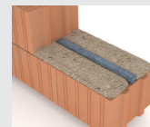
Montaje 3: Junta horizontal de mortero interrumpida por un hueco de 30 mm de espesor relleno con material aislante
