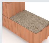
Montaje 1: Junta horizontal de mortero continua
